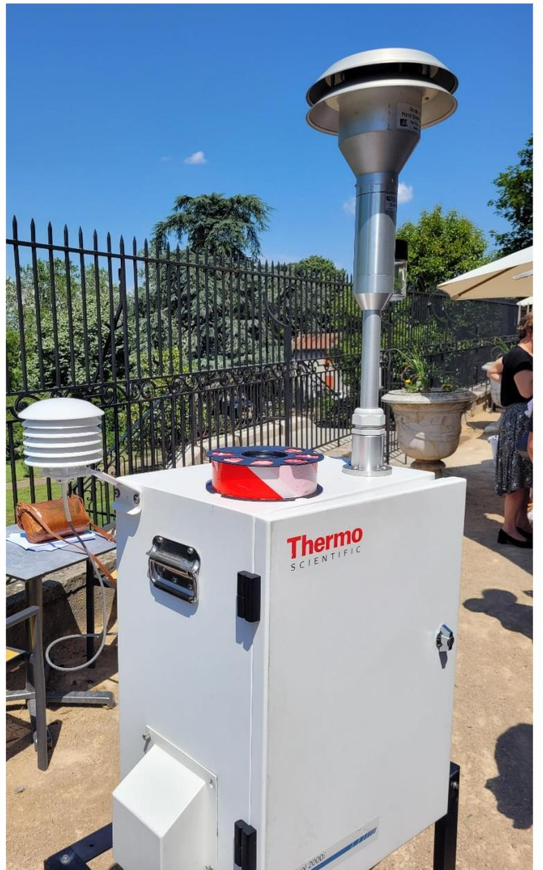
**Fidas 200S de Palas**, station de mesures réglementaires des particules fines de PM1 à PM10 (agrée par l'UE) est proposée à un coût de 40 000 €.
